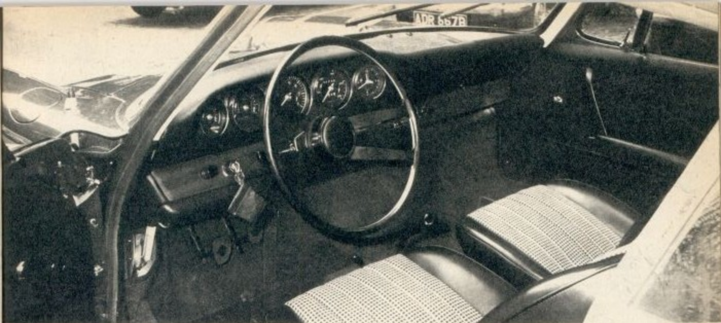
Tous les appareils de contrôles, noyés dans un tableau de bord bois et cuir sont groupés devant le pilote, le compte-tours occupant la position centrale. Toutes les commandes d'essuie-glace, indicateur de direction et phare-code sont réparties à droite et à gauche de la colonne de direction.
